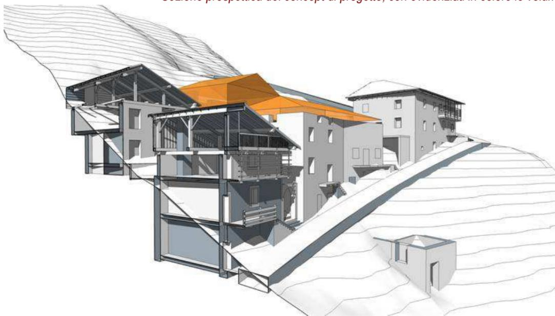
*Sezione prospettica del concept di progetto, con evidenziati in colore le volumetrie da ricostruire*
