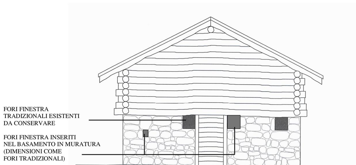
Struttura a “Blockbau” - fronte principale
