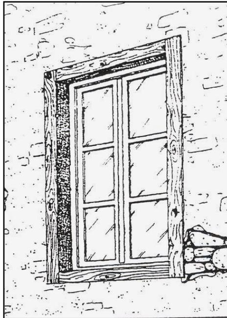
Contorno al foro finestra costituito da un telaio totalmente in legno grezzo, generalmente non levigato né verniciato.
